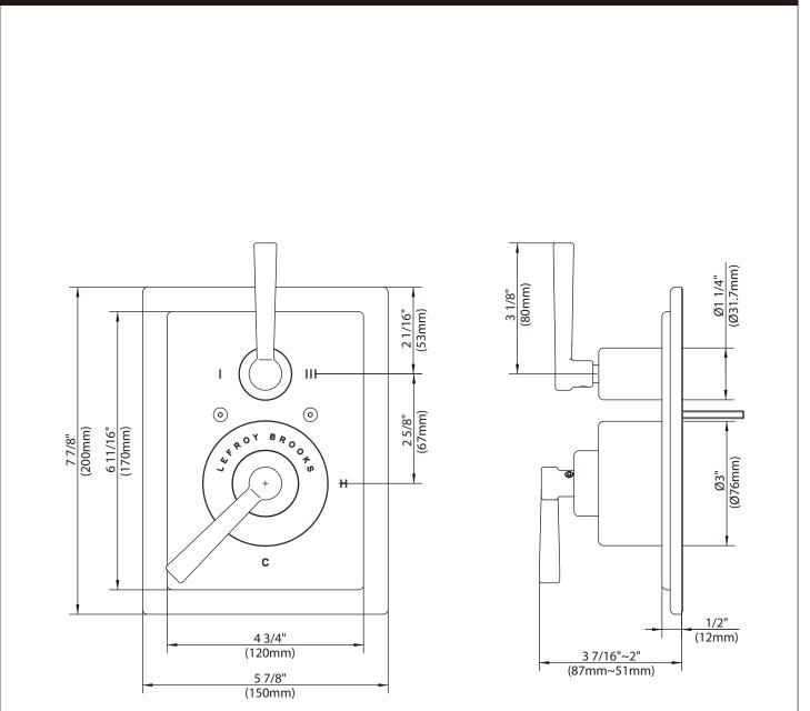
M1-4309 LEVER PRESSURE BALANCE WITH LEVER 3-WAY DIVERTER TRIM ONLY, TO SUIT M1-4102 ROUGH
